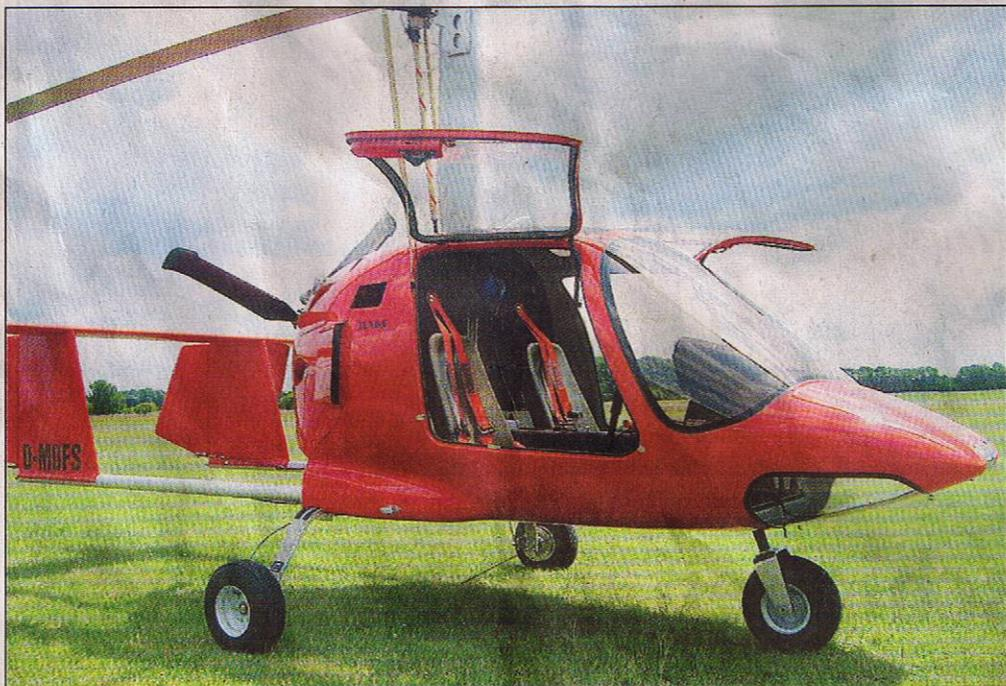
Auf dem Flugplatz im Lohner Klei ist der Gyrokopter noch der Exot. Kurven und die Flughöhe werden durch das Neigen der Rotorebene durch die beiden äußeren Stäbe gesteuert, für den Start wird der Rotor durch die Welle in der Mitte vom Motor zusätzlich angetrieben.
